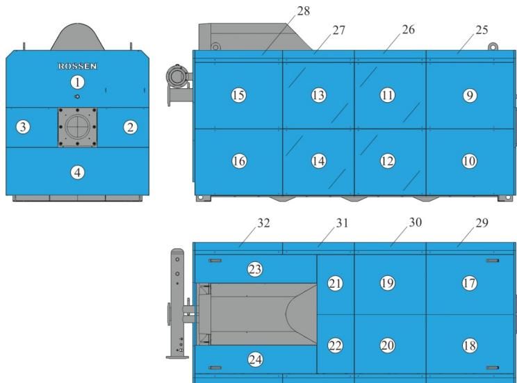
Рисунок 4. Последовательность демонтажа элементов обшивки котла
