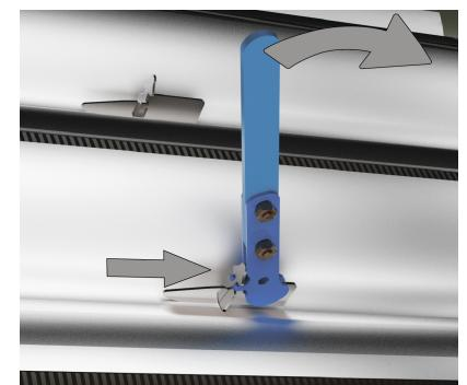
Рисунок 12. Демонтаж отражателей
