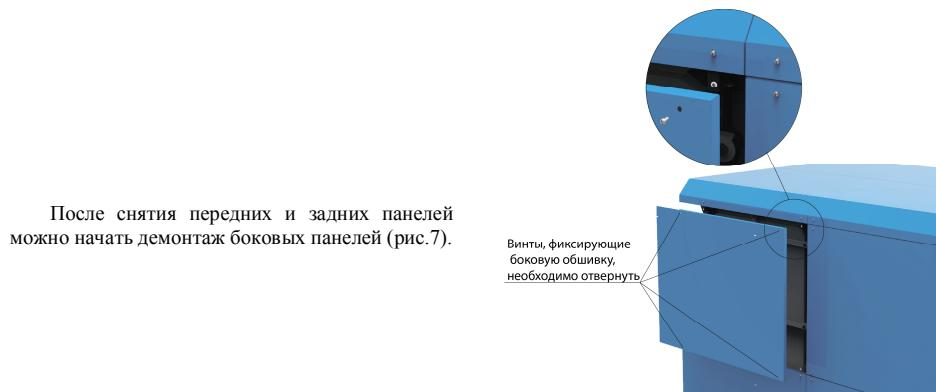
Рисунок 7. Демонтаж боковой обшивки котла
