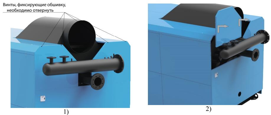
Рисунок 6. Демонтаж торцевой обшивки котла
