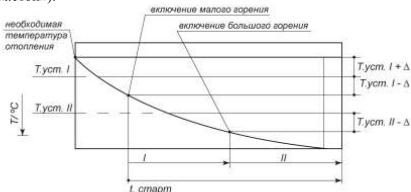
Рисунок 16. Динамика работы котла при охлаждении
