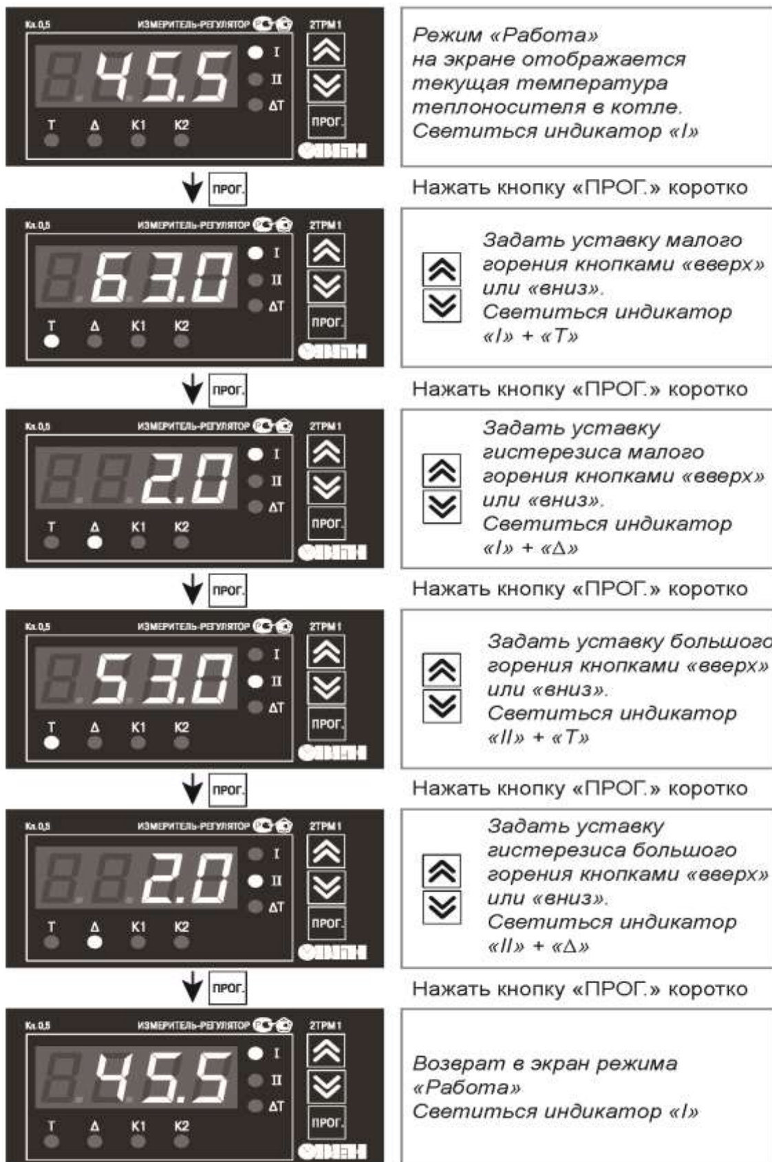
Рисунок 17. Изменение уставок малого и большого горения котла
